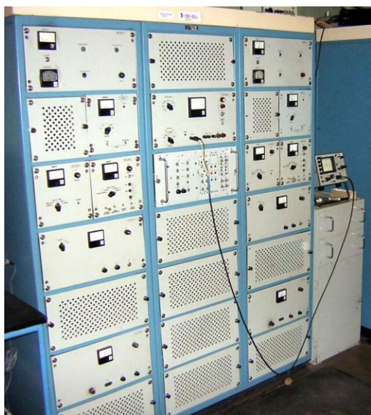
Телевизионный передатчик РЦТА (ламповый, P_{\text{вых.}} = 100 \text{ Вт} )
