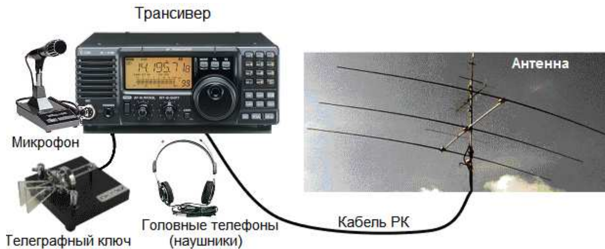
Рис.2.2. Элементы любительской радиостанции
